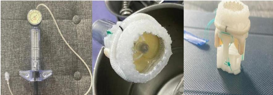
Figura 4. Componentes de una válvula biológica percutánea (intuity-Edwards). Cortesía de archivo personal del Hospital General de México.
